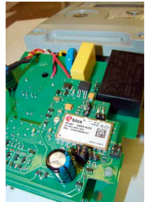
Прибор учета электроэнергии ЦЭ2726А со встроенным модулем NB-IoT
